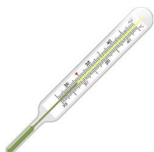
चित्र नं. ६.५ (क) मर्करी थर्मोमिटर
